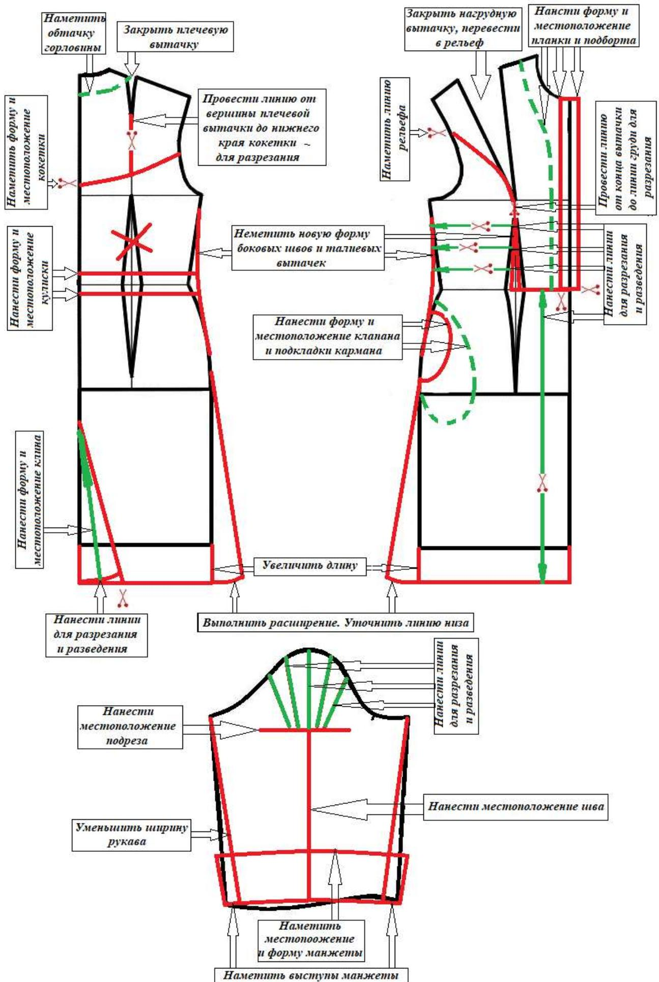
**Готовые выкройки модели – результат моделирования
